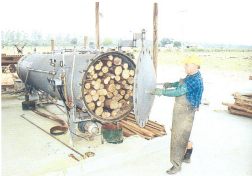
Funcionário da empresa Tratasul maneja autoclave para o tratamento de mourões
