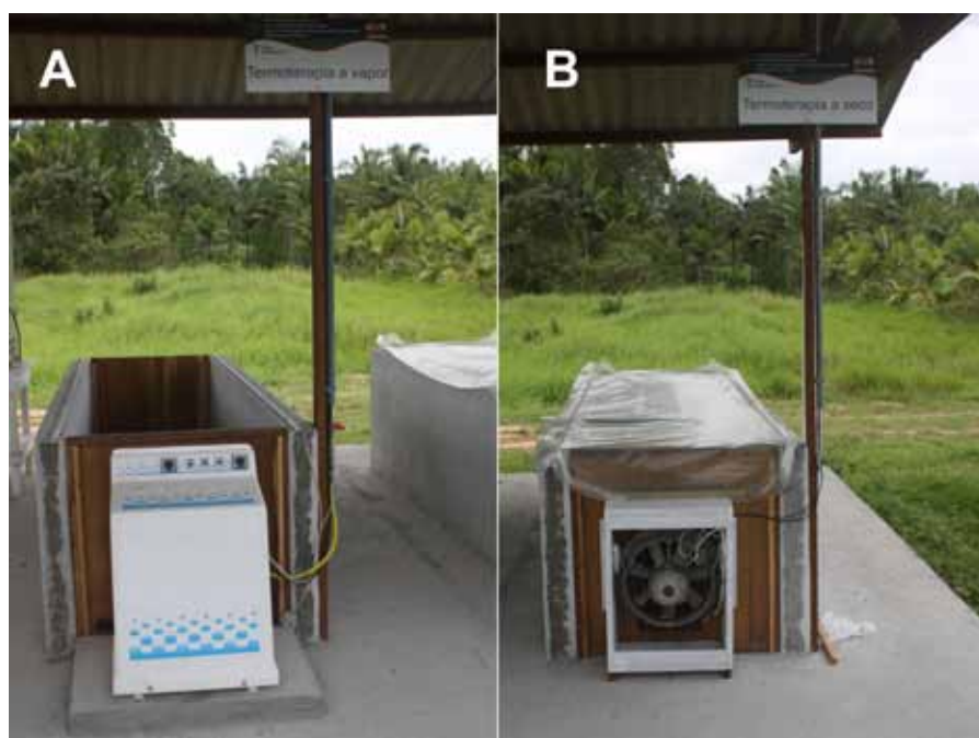
Figura 2. Tratamentos com calor: (A) vaporizador de água e (B) ar seco
