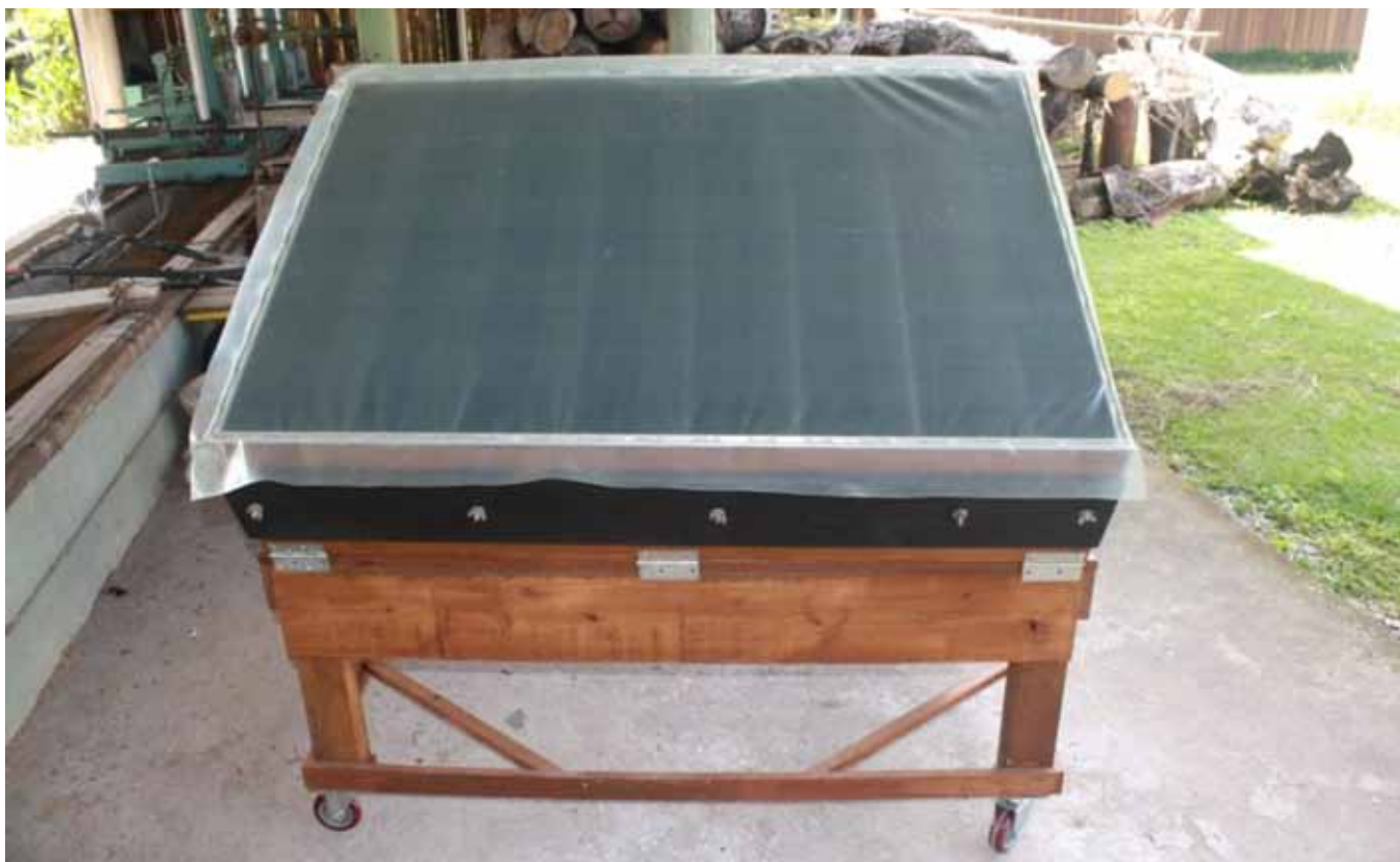
Figura 5. Coletor solar para desinfestação de substrato
