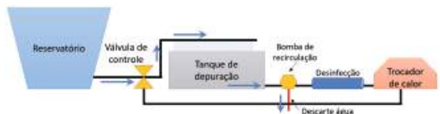
Figura 2. Desenho esquemático das principais unidades da depurada. As tubulações do sistema foram adaptadas para permitir a realização do ensaio. A principal adaptação está destacada em vermelho, usada para descartar a água a ser substituída durante o experimento. Autor: Luis Hamilton P. Garbossa
