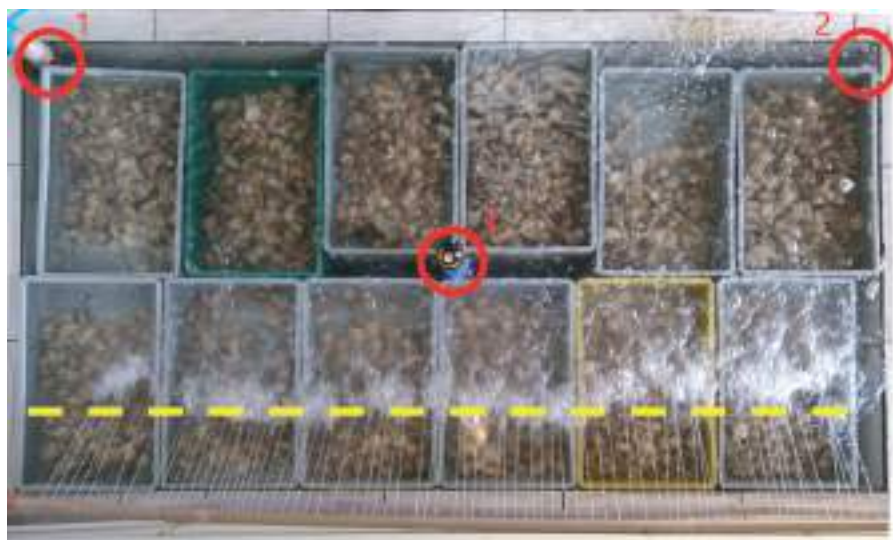
Figura 3. Vista superior do tanque da depuradora. Os círculos vermelhos marcam os locais onde as sondas multiparâmetros foram instaladas com destaque para o Ponto 1, local de coleta da água no ponto de drenagem do tanque. A linha tracejada amarela marca o local de abastecimento de água no tanque
