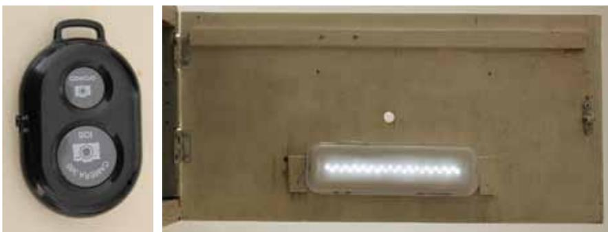
Figura 4. Acionador Bluetooth para disparo da câmera do celular (a) e luminária para iluminação da câmara de aquisição de imagens digitais (b)
