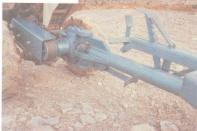
...e detalhe da tomada de força de giro livre com três correias
