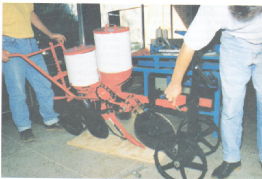
Detalhe da junta móvel que facilita o trabalho em curvas de nível
