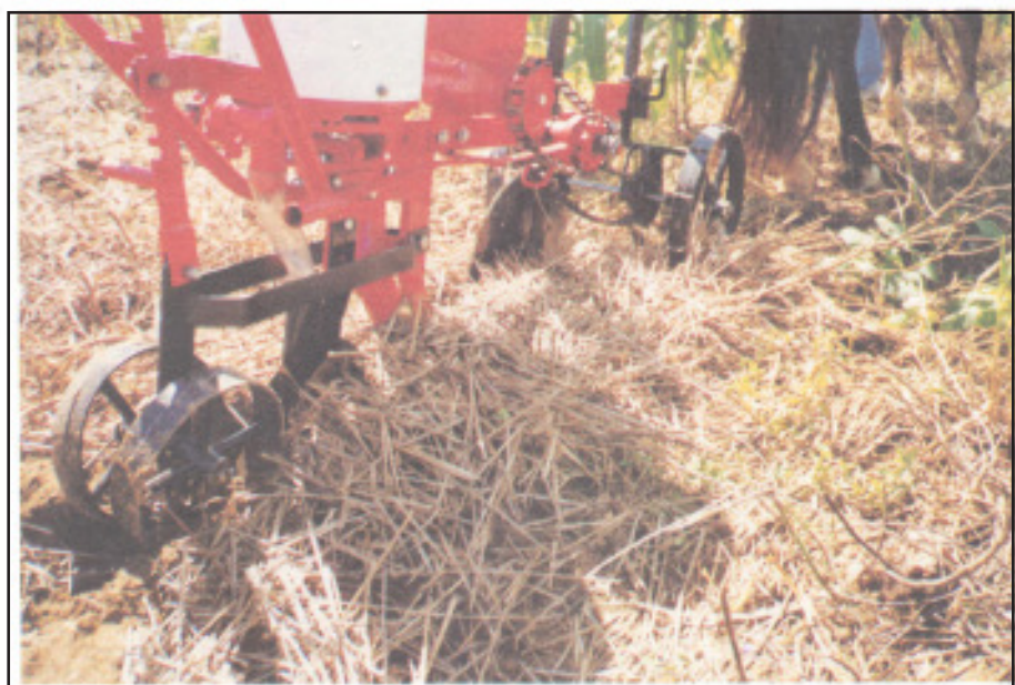
Três operações numa só: disco corta a palha, sulcador abre o sulco e as duas canaletas posteriores despejam o adubo e as sementes
