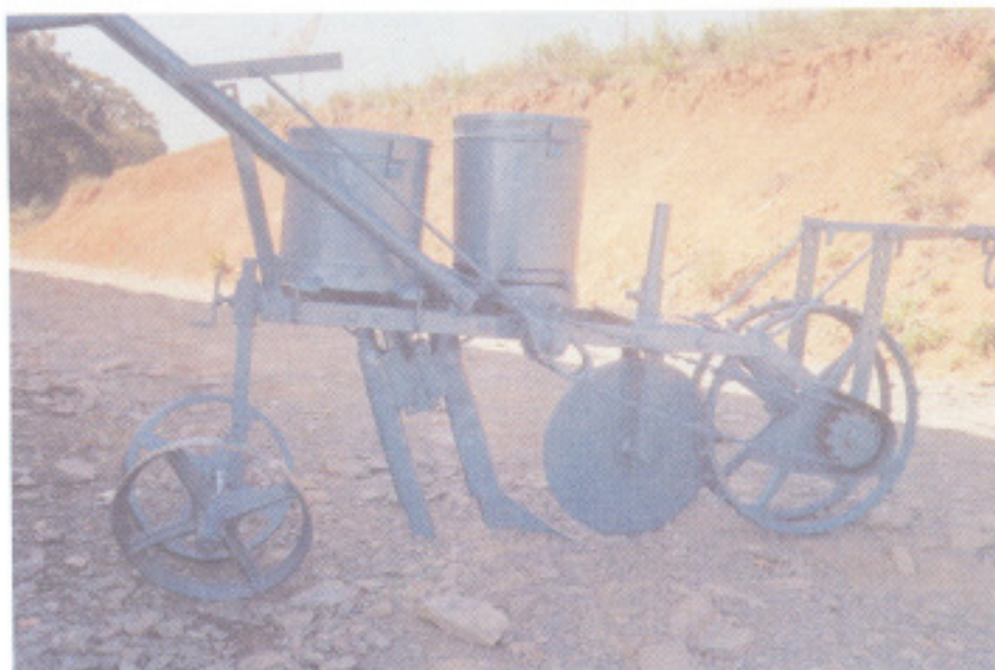
Disco de corte na semeadora de tração animal fica próximo das rodas tracionadas, facilitando o corte da palha
