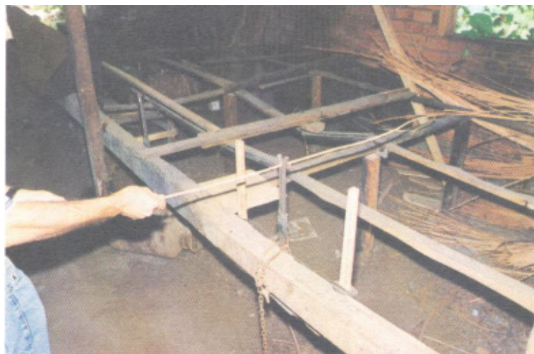
Após cozimento, varas são descascadas artesanalmente utilizando ferros de construção
