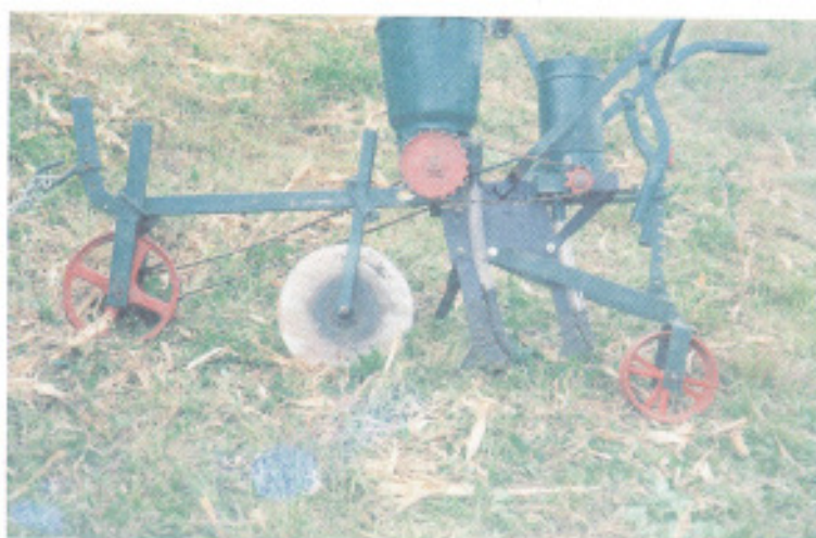
Nova posição dos condutores de sementes e adubos: para trás, em ângulo
