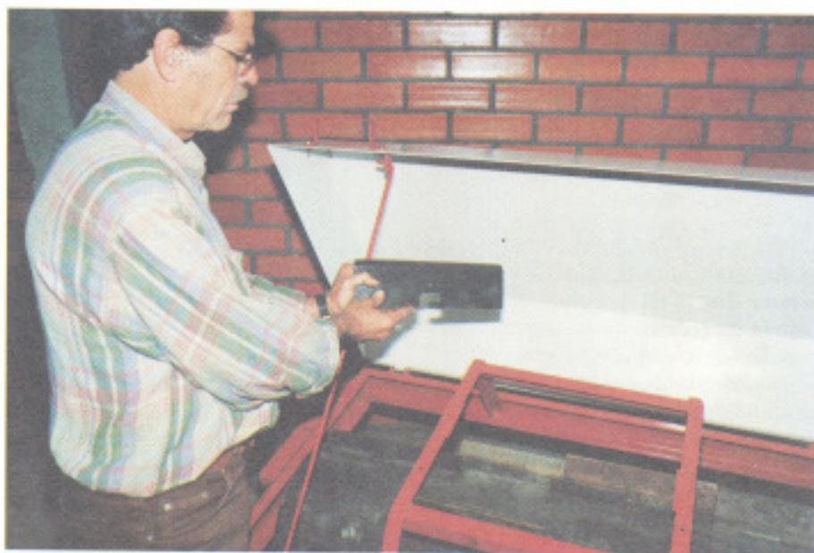
José Beltrame mostra o novo modelo de rolo-facas com lâminas menores e o encaixe da faca
