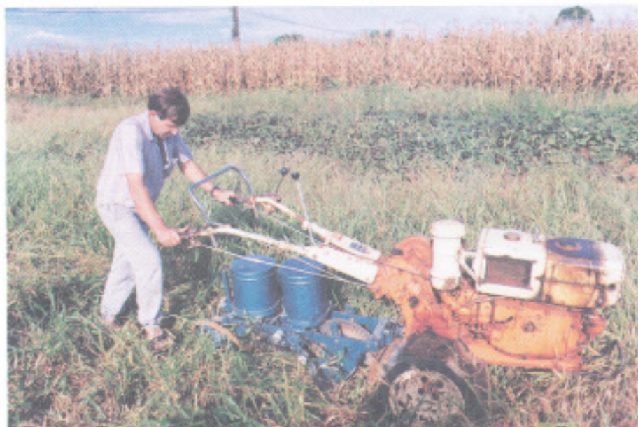
Jair Hoeltgebaum testa a semeadora-adubadeira acoplada ao microtrator
