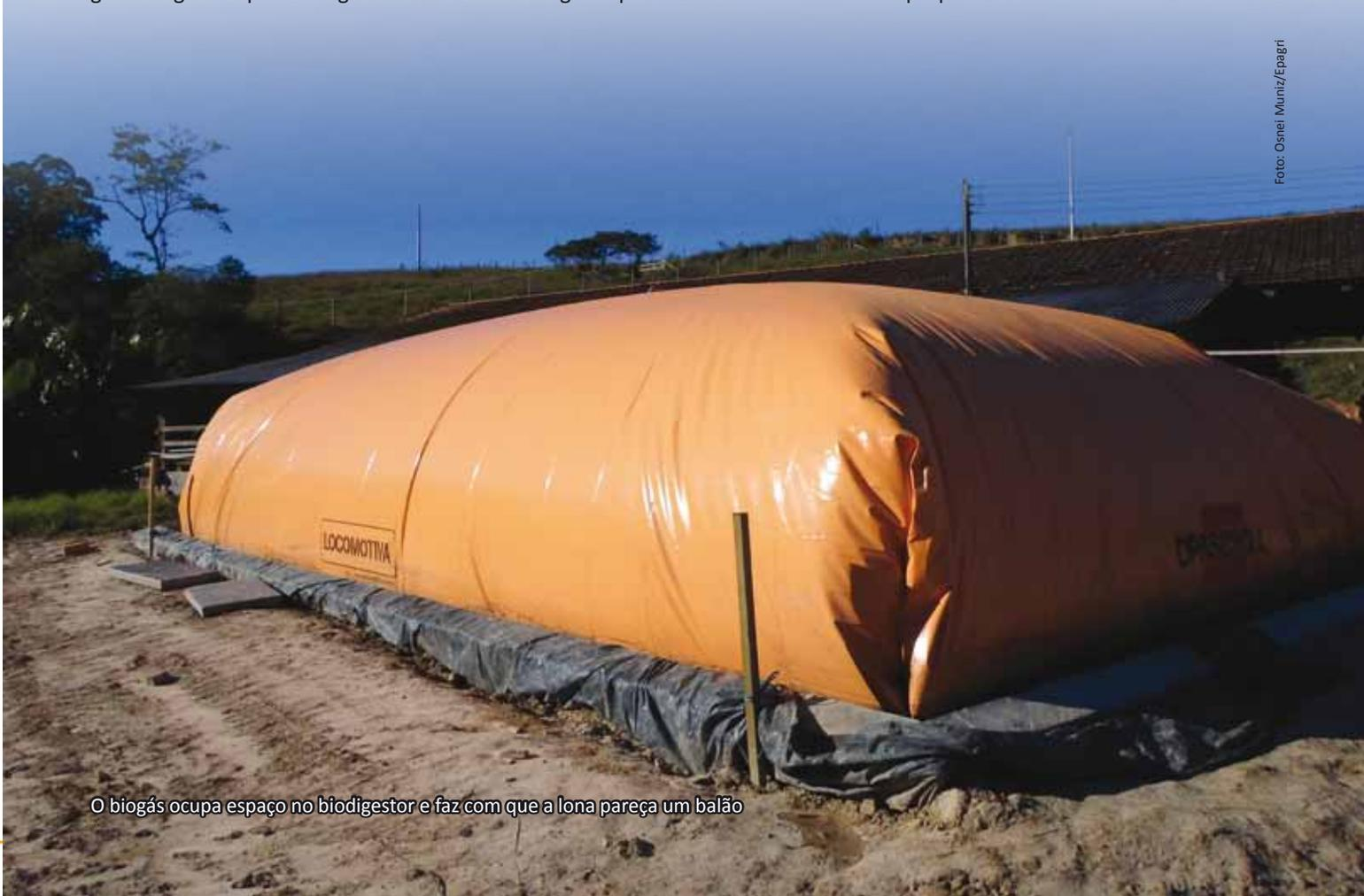
O biogás ocupa espaço no biodigestor e faz com que a lona pareça um balão
