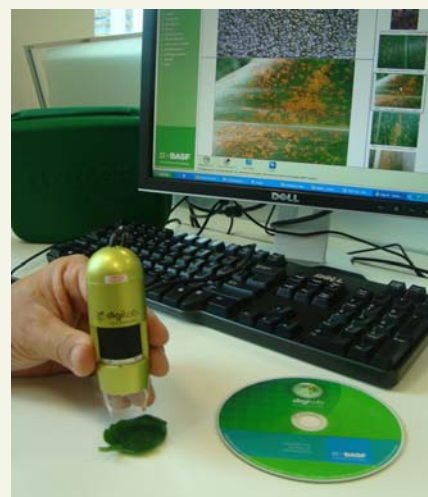
Microscópio digital amplia a imagem em até 200 vezes
