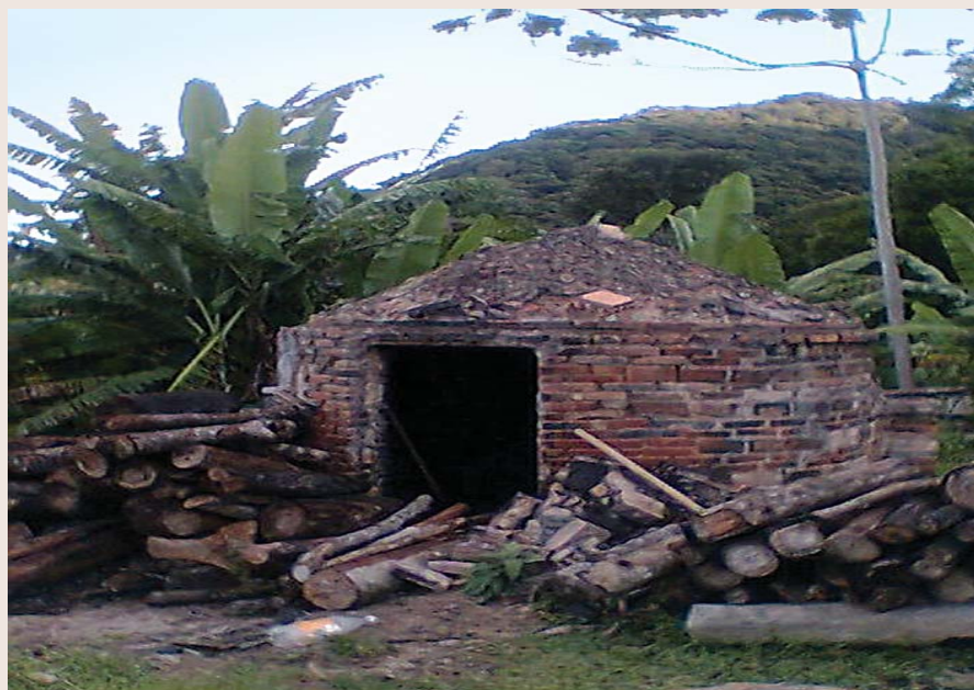
Forno para produção de carvão vegetal em comunidade rural de Biguaçu, SC, em 2008
